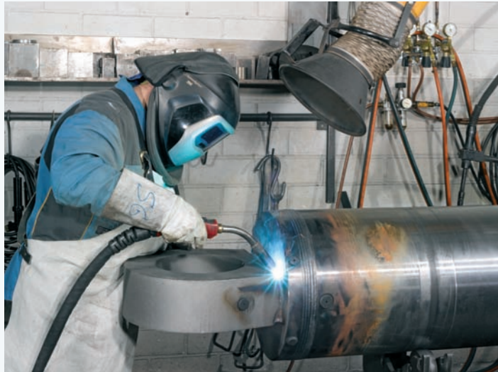
Das Aufschiessen einer Öse auf das Zylinder-Mantelrohr erfordert höchste Präzision, denn dieses Teil überträgt später die gesamte Kraft des Zylinders.
