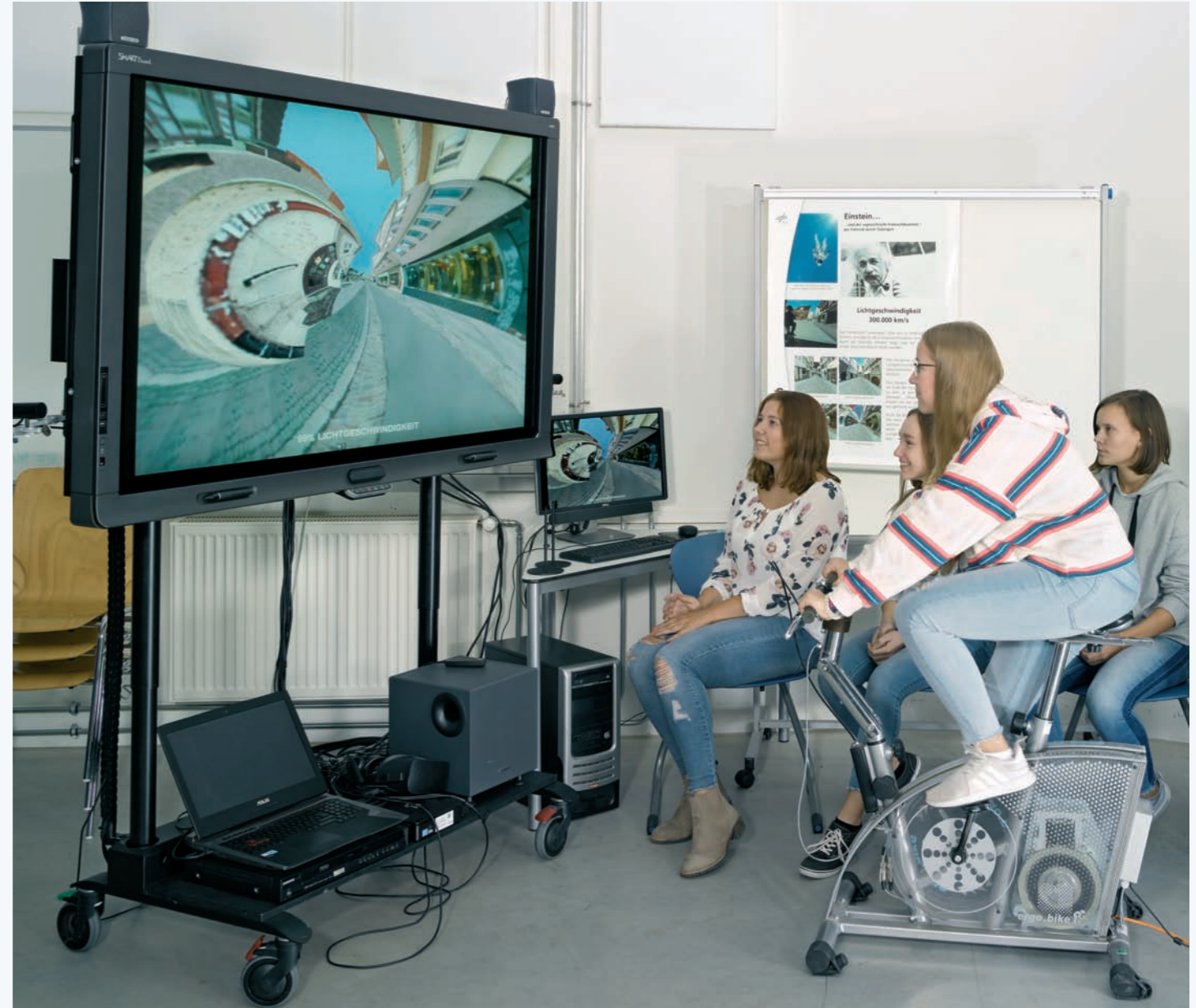
Beim Experimentieren mit dem sogenannten „Einstein-Fahrrad“ bewegt man sich, zumindest virtuell, fast mit Lichtgeschwindigkeit. Per Computer werden verschiedene Effekte der speziellen Relativitätstheorie zugeschaltet und an einem Bildschirm visualisiert.
