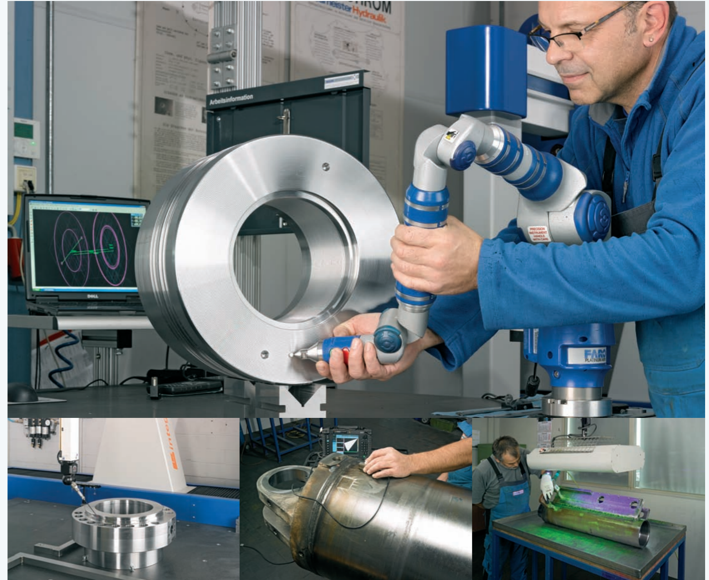
Mit dem Messarm wird die Maßhaltigkeit gemäß Qualitätsnorm überprüft und bestätigt. Die vollautomatische Messmaschine überprüft durch programmgesteuerte Messschritte die Zeichnungskonformität des Teils. Die Ultraschall-Prüfung belegt, dass Schweißnähte fehler- und lunkerfrei ausgeführt sind.
