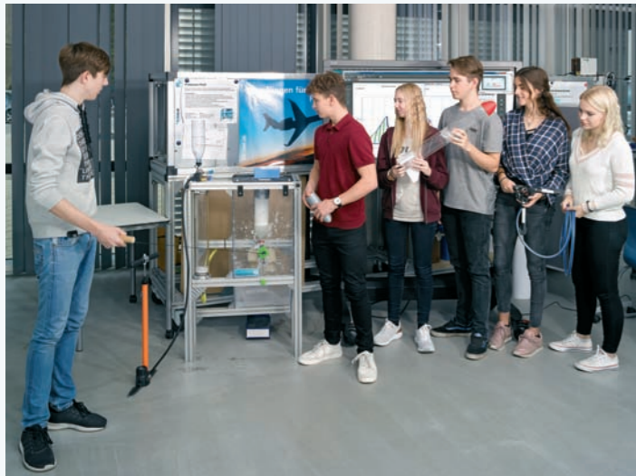
An einem Prüfstand für Wasserraketen können verschiedene Konfigurationen getestet werden, um im Anschluss mit den gewonnenen Erkenntnissen die selbst gebaute Rakete zu optimieren.
