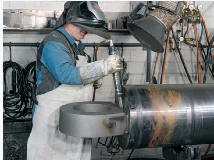
Präzision, die man sehen kann: Die Schweißnaht-Nachbearbeitung ist ein typisches Qualitätsmerkmal aller Produkte von Neumeister Hydraulik.
