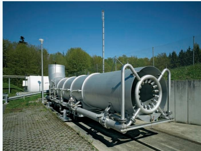
Bei höherem Schub und höheren Brennkammerdrücken der getesteten Triebwerke wird ein Leitrohr zur Schallreduktion eingesetzt.
