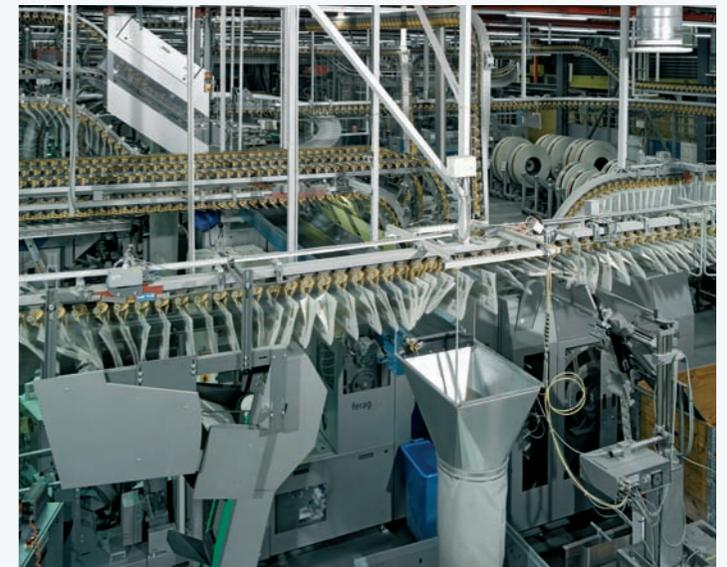
Nach dem Druck laufen die Zeitungen in einen Sammelhefter, werden verpackt und in der Nacht zu den Austrägern gebracht, die sie an die Abonnenten verteilen.
